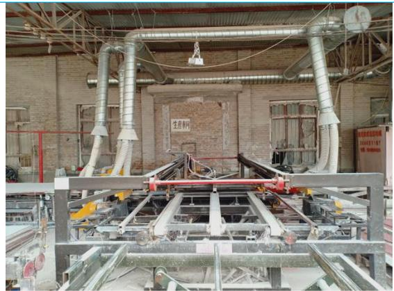
切割工序粉尘收集装置
